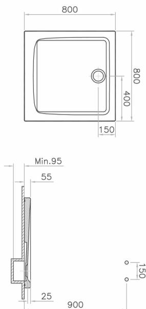
**Description:** Arkitekt receveur à encastrer ou à poser extra plat, classification antidérapant A/PN12, 80x80cm, céramique sanitaire, bonde Ø 90 mm, sans système d'écoulement. Decaissement nécessaire!
