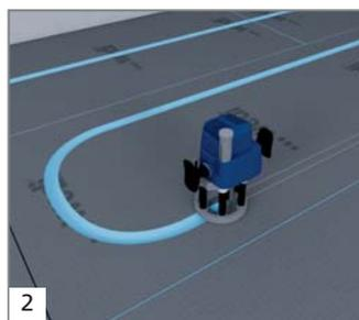
2 Fraisier les rainures à l'aide d'une défonceuse. La largeur de fraisage devrait être égale à celle des tuyaux et la profondeur devrait être au moins de 3 mm plus importante.
