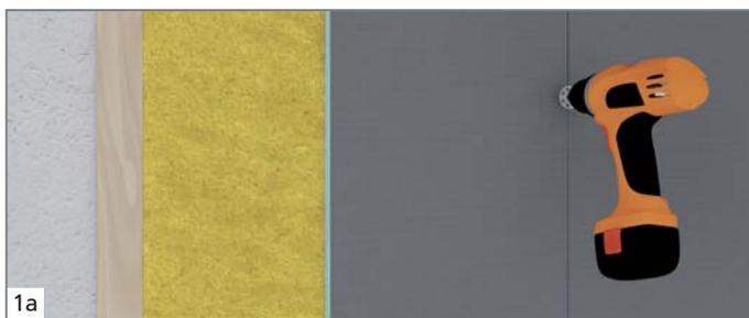
À l'aide de vis à fixation rapide ou de vis à placo et de rondelles d'isolation wedi *Tools*, visser entièrement le panneau de construction sur la structure métallique ou sur la structure en bois...
