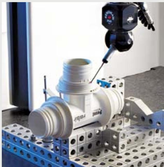
Bravopress® est un système de raccords dotés de caractéristiques mécaniques exceptionnelles du polifenilsulfone et qui présente les avantages d'un raccordement à l'aide d'un sertissage avec une bague en acier.
