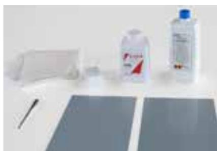
1. Se munir du matériel de soudure. Dans le cas d'un matériau filmé, dégager proprement le film protecteur sur la zone à souder.
