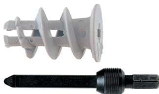
Cheville plastique, idéale pour fixations de charges légères dans les panneaux de carton-plâtre. La mise en œuvre s'effectue en vissant directement la cheville dans le panneau à l'aide de l'outil de pose joint à chaque boîte. Un espace de 20 mm derrière le panneau suffit à une bonne mise en œuvre. A utiliser dans : cloisons sèches, plaques de carton-plâtre. Pour fixer plinthes, interrupteurs, tringles, appliques, accessoires, ?
