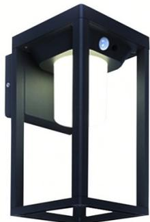
Applique à fonctionnement solaire roma 3000°k 300lm (sans branchement électrique). Détecteur de mouvement intégré de 2 à 5 m. Temporisation 30 sec. Détection infrarouge avec un angle de 120°. 4 modes possibles dès 20 lux : ON / veille 50 lm, veille + détection 100% pendant 25 sec puis veille, 0% + détection 100% pendant 25 sec puis extinction, OFF. Allumage des LED au crépuscule automatique. En aluminium et polycarbonate. Finition gris anthracite. IP55 IK07.
