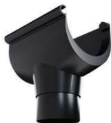
La naissance centrale à dilatation libre est résistante aux UV, à la corrosion et aux chocs mécaniques et thermiques. Elle s'emploie avec les gouttières demi-rondes de 25. Destinée à l'évacuation des eaux pluviales et convient à la maison individuelle.
