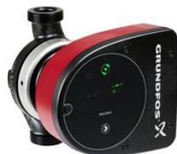
Circulateur à vitesse variable à haut rendement énergétique conforme à la directive ErP. Indice d'efficacité énergétique en dessous des exigences de la directive ErP pour 2015. Indication du fonctionnement et de défaut. Mode de régulation : 3 courbes régulation pression constante, 3 courbes régulation proportionnelle, 3 courbes constantes. Livré avec coquille d'isolation. Entraxe 180 mm.
